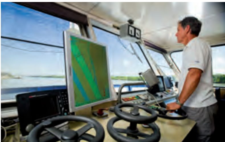
Pillanatnyi forgalmi helyzetkép megjelenítése elektronikus navigációs térképen
