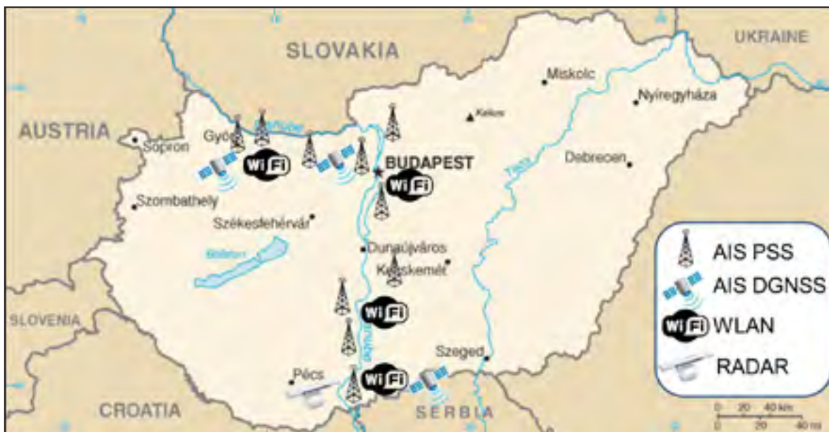
A PannonRIS rendszer parti infrastruktúrájának áttekintése
