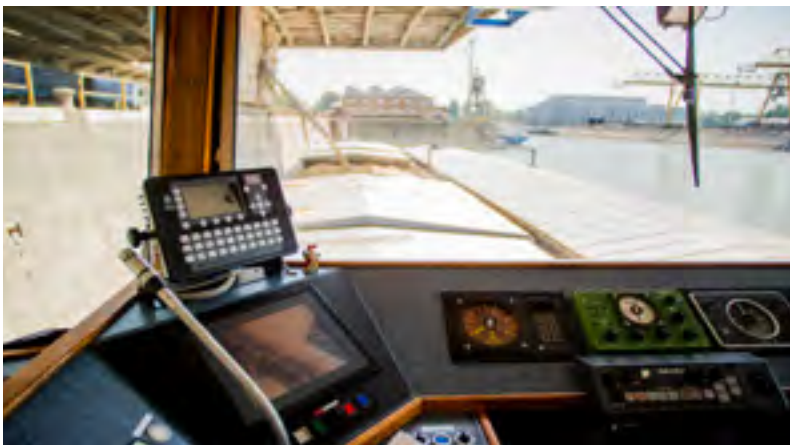
AIS transzponder készülék a Fluvius Kft. egyik magyar lobogójú belvízi hajója fedélzetén
