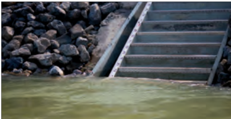
Szintmérő lécc egy vízállásmérő ponton; a vízszint a jelen ponton 95 cm
