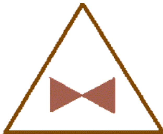
Gyorselzáró szelep tartályon
